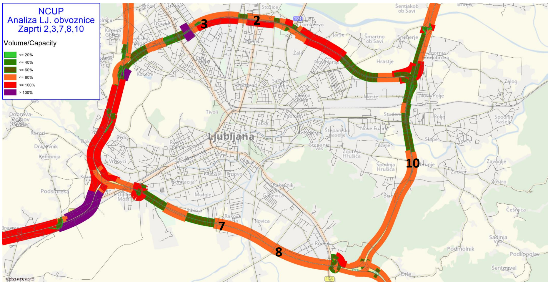
Slika 4: Prikaz zasičenosti prometa na Ljubljanskem obroču, upoštevan scenarij zaprti določeni priključki PLDP 2021
